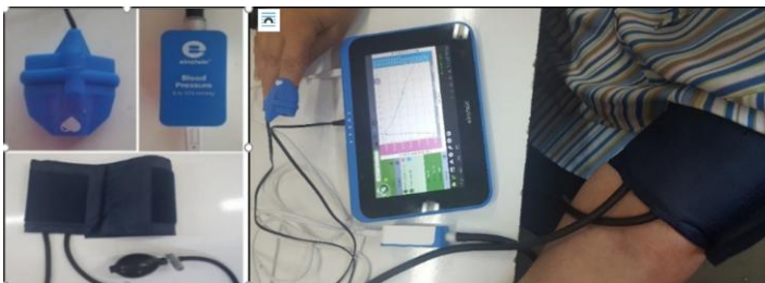
Figura 3.5: Părțile componente ale dispozitivului experimental: pulsometrul (stânga sus), senzorul de frecvență cardiacă (stânga sus) și tensiometrul (stânga jos); dispozitivul experimental folosit pentru determinarea tensiunii arteriale (dreapta) [30]
