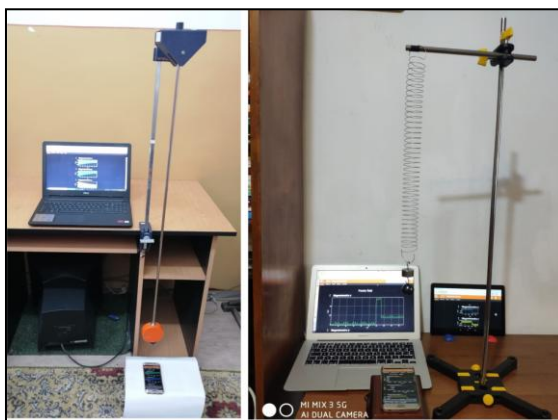
Figura 4.21: Dispozitivele experimentale folosite în studiul mișcării oscilatorii amortizate: pendulul gravitațional (stânga); pendulul elastic (dreapta)
