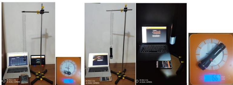
Figura 4.30: Dispozitivul experimental utilizat pentru determinarea constantei elastice a unui resort, folosind magnetometrul încorporat al unui smartphone și conexiunea cu alte dispozitive (stânga) și folosind senzorul de lumină (dreapta) [87]
