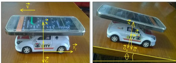
Figura 4.8: Dispozitivul experimental folosit pentru determinarea coeficientului de frecare la alunecare pe plan orizontal și pe plan înclinat, utilizând telefonul inteligent
