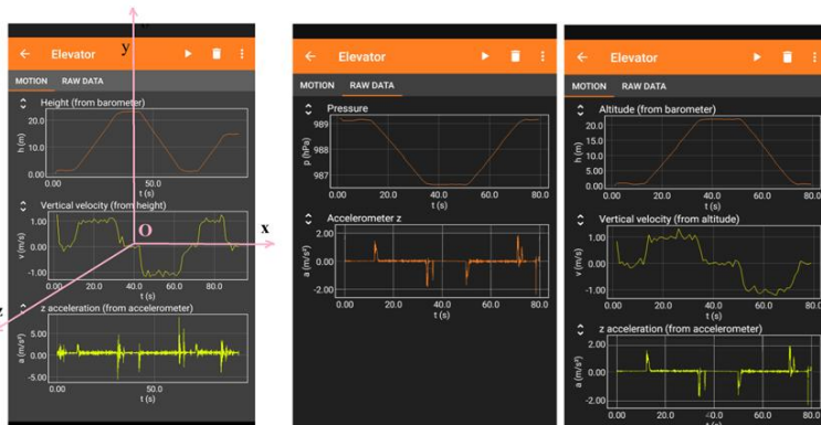
Figura 4.16: Sistemul rectangular de axe Oxyz atașat smartphone-ului (stânga); variațiile presiunii, altitudinii, vitezei și accelerației în timpul mișcării liftului (dreapta); captură de ecran Phyxox [77]
