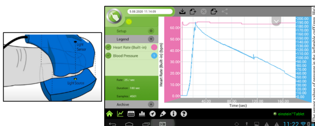
Figura 3.7: Amplasarea sursei de lumină și a senzorului de lumină în interiorul unui monitor de ritm cardiac (adaptare https://www.youtube.com/watch?v=uOFBhM3cG ) (stânga); graficul pentru ritmul cardiac (bpm) și presiunea în manșetă în funcție de timp; captură de ecran MiLAB™ (dreapta)[30]
