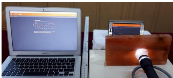
Figura 4.5: Dispozitivul experimental folosit pentru studiul legii lui Bouguer - Lambert. Versiunea color completă poate fi accesată la http://www.rrp.nipne.ro [63]
