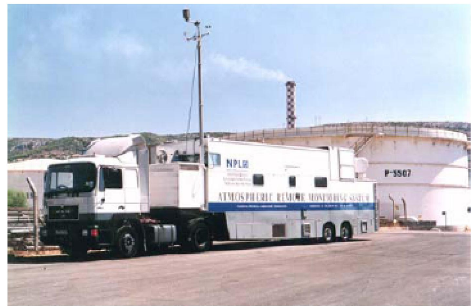
LIDAR mobil realizat pentru determinări de poluanți operat de National Physical Laboratory, Londra, UK
