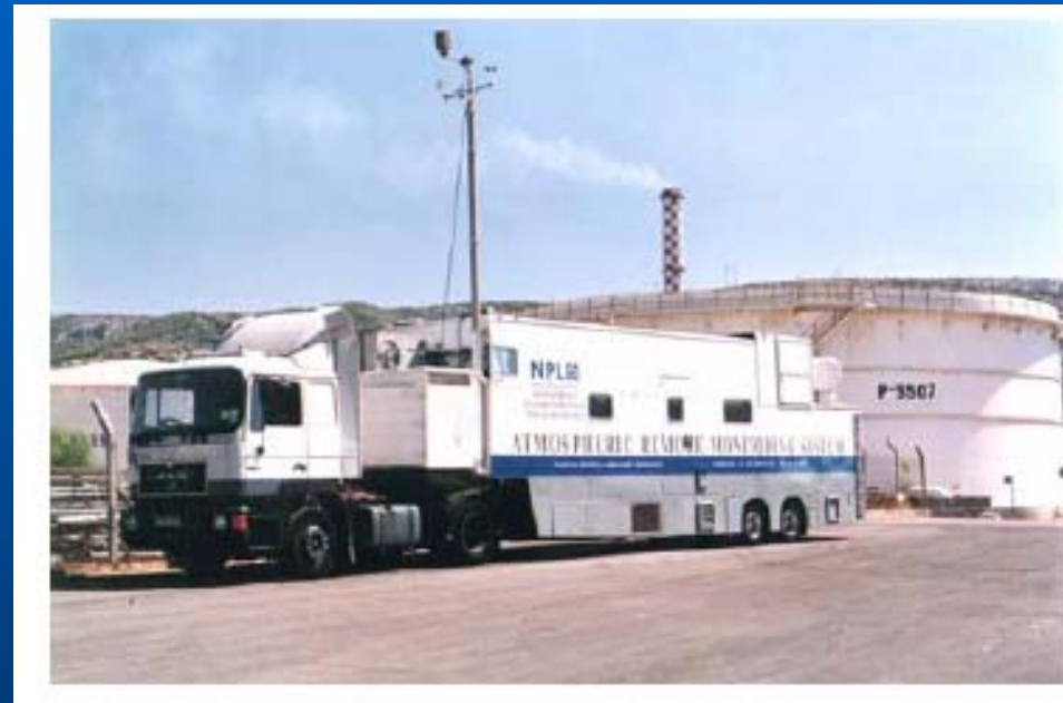
LIDAR mobil realizat pentru determinări de poluanți operat de National Physical Laboratory, Londra, UK
