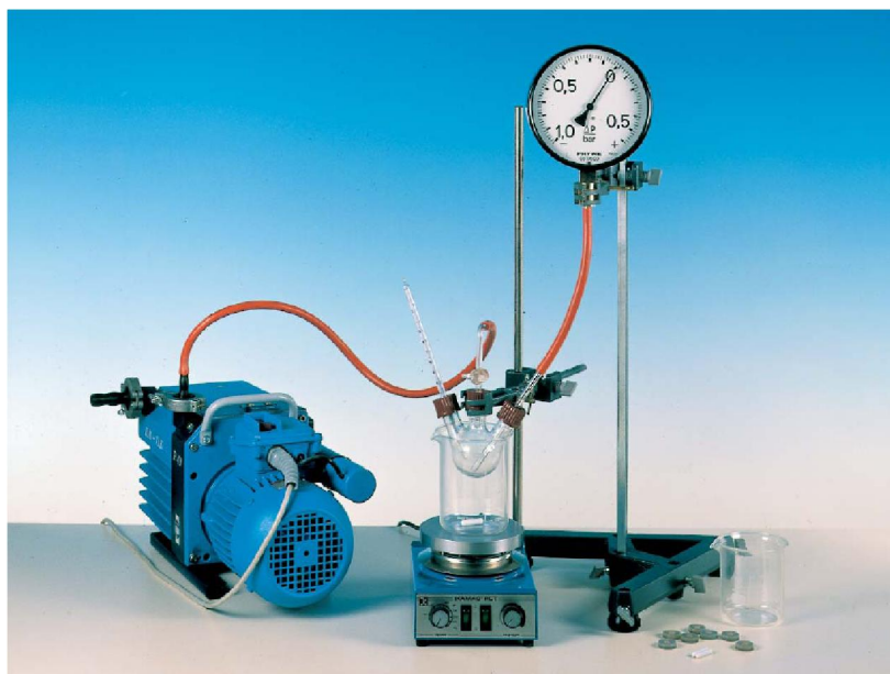
Figura 1. Dispozitivul experimental pentru măsurarea presiunii de vapori a apei sub 100^{\circ}\text{C}
